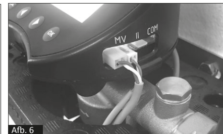
PT-PRO / PROD: aansluitingen rechts: magneetventiel (MV), geleidbaarheidssensor (II), voorbereiding bidirectionele communicatie (COM)
