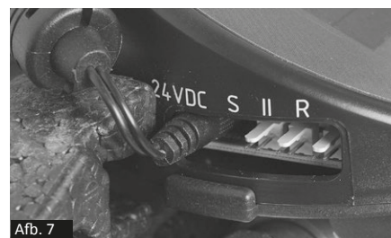
PT-PRO / PROD: aansluitingen links: 24V, impulsleiding (S), geleidbaarheidssensor (II), signaalleiding (R)
